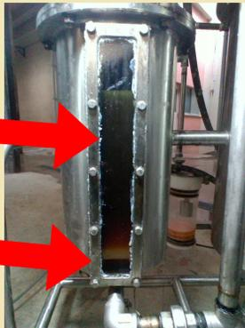
③底に沈殿したグリセリンを抜き、廃油を取り出す
